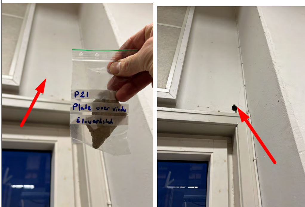
Bilde B21: P21 Plate over vindu, el-verksted. Fasade sør, verkstedsfløy. 80-tallsbygg(del 4)
