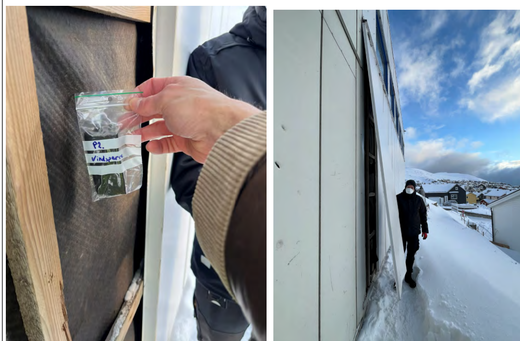
Bilde B2: P2, Vindsperre, Fasade Sør (del 2), 80-tallsbygg.
