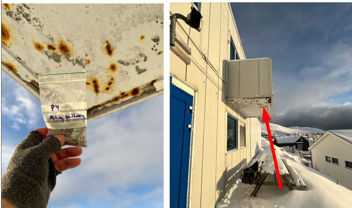
Bilde B4: P4, Betongmaling balkong, Fasade sør (del 1), 50-tallsbygg.
